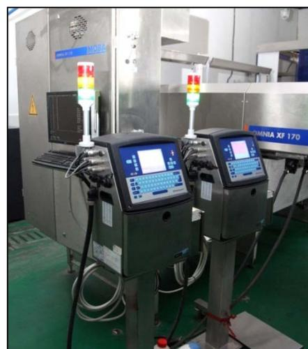
Diese Position ist auch die anspruchsvollste in Bezug auf Geschwindigkeit, Platzbedarf und Umgebung. Bei einem Sortierer mit einer Geschwindigkeit von 45 m/min muss der Drucker das Ei mit ca. 40 m/s bedrucken, unabhängig davon, ob der Druck von Pol zu Pol oder quer über die Oberseite des Eis erfolgt. Während dieser Zeit kann der CIJ-Drucker zwei Textzeilen drucken.
