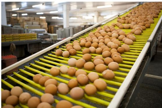
Der Wartungsbedarf richtet sich in hohem Maße nach dem Standort der Codieranlage und den Reinigungsverfahren. Eine integrierte Eiercodierung direkt hinter dem Transferbereich befindet sich womöglich im schmutzigsten Bereich, da die Sortierer Eier in diesem Bereich häufig auswerfen, Eier manchmal aus den Greifern rutschen und Wasser sowie Brucheier tropfen. Es ist wichtig, Verfahren einzurichten, die sicherstellen,
